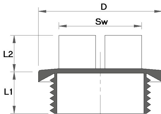
Tappo filettato con testa esagonale per la protezione di filetti femmina, montaggio avvitato.
