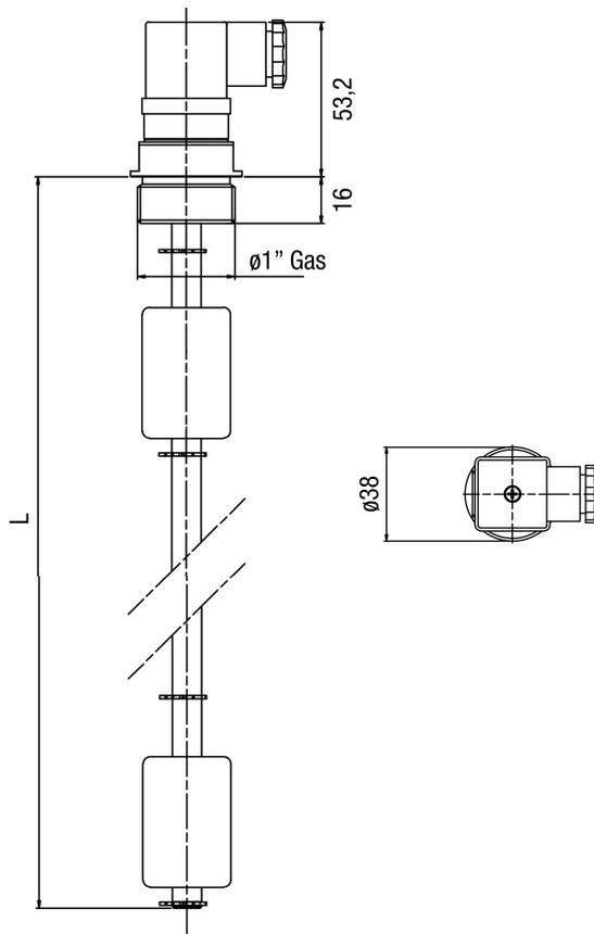
Livellostato indicato per l'impiego in applicazioni oleodinamiche, impianti di lubrificazione, veicoli industriali, stoccaggio fluidi e macchine idropultrici. Un'ampolla reed alloggiata nell'asta viene sollecitata da un campo magnetico generato da un magnete contenuto nel galleggiante che, scivolando lungo l'asta seguendo il livello del liquido, fa commutare il contatto elettrico. Articolo certificato RINA.
