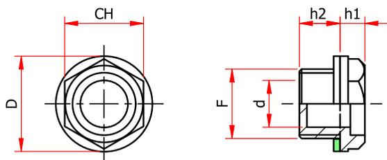
Spia livello olio a testa esagonale in plastica con filetto chiuso all'interno. Il disegno della zona filettata esclude la possibilità che eventuali residui di olio ristagnino all'interno del visore, evitando quindi l'impressione della presenza di liquido anche quando questo è sceso sotto il livello minimo.
