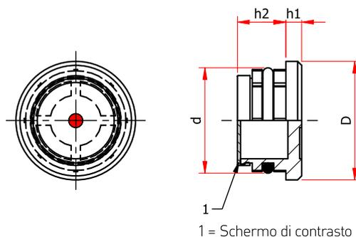
Spia livello olio con montaggio a pressione su fori di  $\varnothing$  F con spessori  $\geq 5$  mm e con tolleranza del diametro da  $\pm 0,1$  mm, smusso d'imbocco 1/45°. Non utilizzare in serbatoi in pressione.
