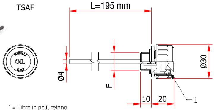
Tappo di riempimento e sfiato con testa cilindrica di 30 mm di diametro e lobi verticali, serraggio manuale, caratterizzato da un'ottima resistenza meccanica, stabilità dimensionale e resistenza agli urti, anche ad alte temperature.
