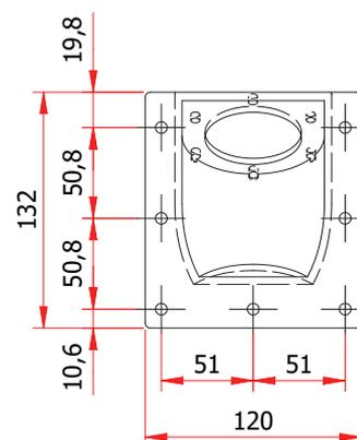
Tappo di riempimento e sfiato con filtro aria. Montaggio con flangia forata e sei viti di fissaggio, attacco a baionetta.
